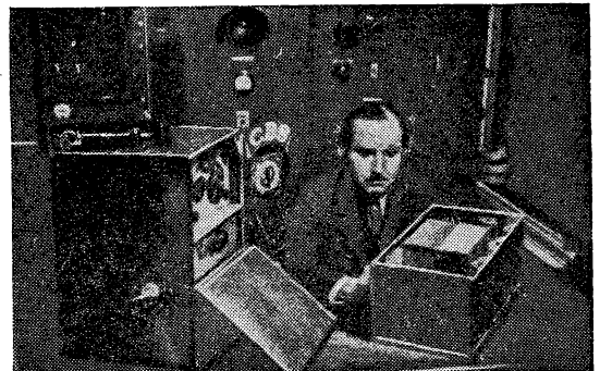
Рис. 3. Один из инженеров лаборатории слушает передаваемые распоряжения. Для ответной передачи на его рабочем столе имеется такой же у.к.в. передатчик с микрофоном. Передатчики, используемые для такой внутренней связи, обладают мощностью в 1 W. Длина их волны равна 5 м
